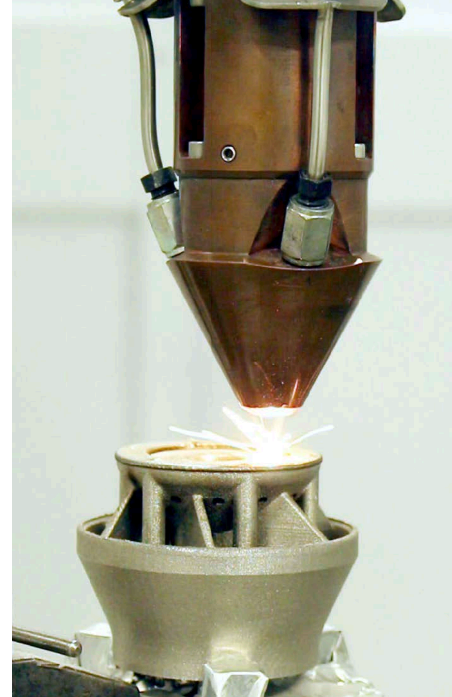
LPA-Materialauftrag auf einen SLM-gefertigten Gasturbinenbrenner
