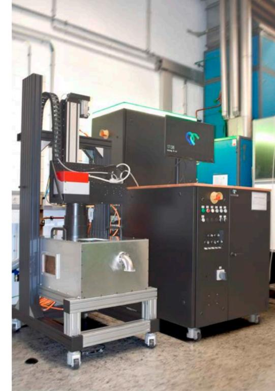
Modulare SLM-Anlage mit Prozesskammereigenbau
